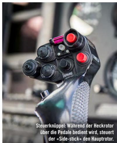
Steuerknüppel: Während der Heckrotor über die Pedale bedient wird, steuert der «Side-stick» den Hauptrotor.
